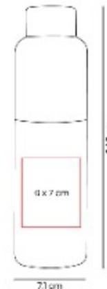
Termo doble pared. Cerrado al vacío. Pared interna y externa acero inoxidable. Tapa metálica con sistema de rosca.
